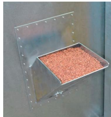
Kupferschütte dient zum geschirmten Einbringen von Datenleitungen in die Absorberkammer. Es muss nicht für jede Art der Datenübertragung ein spezielles Datenleitungsfilter installiert werden.
